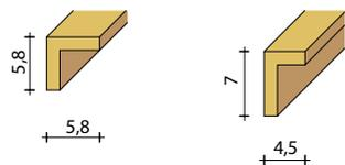
**Profili per cornice palo pino impregnato sezione a "L" spessore 1 cm**
