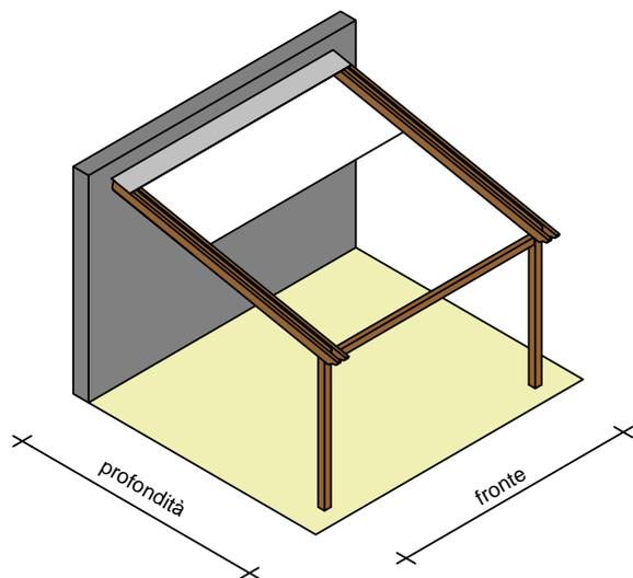
**Pergoline a misura cod. 01165****STRUTTURA 2 COLONNE FRONTALI****Larghezza frontale:** da 200 cm a max 450 cm**Profondità:** da 200 cm a max 550 cm
