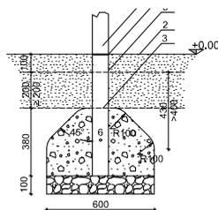
Esempio di fondamenta (dimensioni in centimetri).
