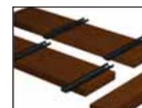
2. Posizionare una piastra alla destra della linea tracciata ad una distanza di 5mm. Sulla tavola successiva ripetere l'operazione posizionando il connettore alla sinistra della linea tracciata, sempre ad una distanza di 5 mm. Procedere secondo questo schema per tutte le tavole.
