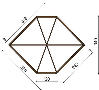
**Kit struttura 327x327 cm h min 238 - max 308 cm pino lamellare acciaio inox**
