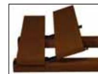
4. Girare la tavola ed infilarla sotto a quella precedentemente fissata sulla sottostruttura.
