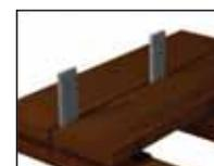
5. Fissare ciascun connettore alla sottostruttura con una vite. Per ottenere la larghezza della fuga desiderata si raccomanda l'utilizzo di distanziatori.
