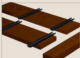
**2** Posizionare una piastra alla destra della linea tracciata ad una distanza di 5mm. Sulla tavola successiva ripetere l'operazione posizionando il connettore alla sinistra della linea tracciata, sempre ad una distanza di 5 mm. Procedere secondo questo schema per tutte le tavole.
