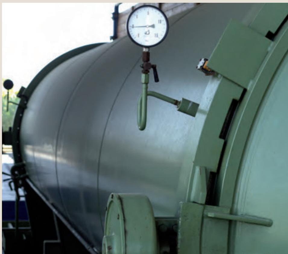
I prodotti impregnati in autoclave possiedono il caratteristico colore verde chiaro, dato dalla presenza del rame nei Sali utilizzati per il trattamento. Per chi desidera un colore più scuro, Alce offre il servizio AlceColor. La tinteggiatura viene effettuata direttamente da Alce con tintura all'acqua color noce e finitura a cera, sui prodotti precedentemente impregnati in autoclave.
