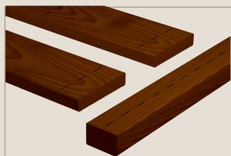
**1** Tracciare una linea indicante la mezzeria del listello sul retro delle tavole da fissare.
