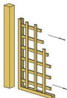
Fissaggio mediante viti mordenti
