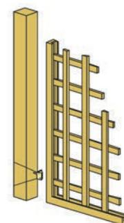
Fissaggio mediante ferramenta a "L"
