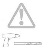
Ø 3 mm Preforo profilo di sottofondo obbligatorio
